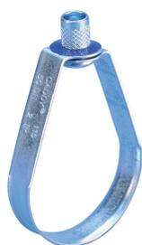
Il collare a pera per applicazioni standard 115M è ideale per sospendere linee di tubi stazionarie e non isolate, compresi i tubi in CPVC degli impianti antincendio a sprinkler. Il nottolino filettato zigrinato aiuta a semplificare le regolazioni verticali, mentre i bordi svasati sulla base (da 1/2" a 4") aiutano a proteggere i tubi dai contatti con bordi taglienti del gancio.
