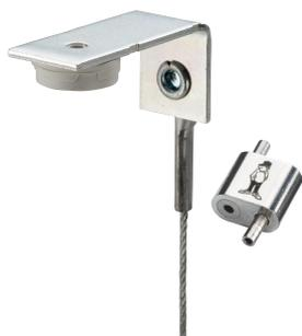
L'imballaggio per applicazioni leggere nVent CADDY Speed Link con squadretta per chiodatrice include una lunghezza pretagliata di un cavo in acciaio di 1 mm rivettato su un angolo della squadretta, che è progettato per il fissaggio diretto insieme a un dispositivo di bloccaggio dal profilo ultra sottile. Gli appaltatori possono installarlo rapidamente e in sicurezza al soffitto in calcestruzzo usando un'ampia gamma di chiodatrici per mantenere e assicurare l'illuminazione e la segnaletica.
