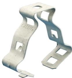
I morsetti per conduit con chiusura a scatto nVent CADDY (serie M) sono un metodo rapido ed efficiente per proteggere i circuiti di derivazione dei conduit per le installazioni elettriche. La serie M è progettata per fornire un posizionamento regolare nell'applicazione eliminando l'offset del conduit e mantenendo lo spazio all'interno delle scatole elettriche. Aumentate l'efficienza dell'installazione utilizzando la nostra gamma completa di conduit per il vostro prossimo progetto elettrico.
