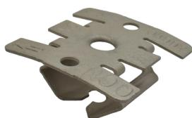
Il dado QSN combina le proprietà esclusive dell'acciaio armonico e la tecnologia "push-to-install" di CADDY per creare un dado per profilo strut con scatto in posizione, rendendo l'installazione di barre filettate o bulloni estremamente rapida. Da utilizzare con un dado esagonale su una barra filettata per una rapida installazione di sistemi di trapezi prefabbricati o con un bullone a testa larga per un montaggio a parete estremamente rapido di scatole elettriche e altri servizi.
