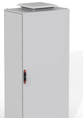
Questa ventola con filtro da tetto, RFU, con grado di protezione IP 33 o 54, è facile da montare grazie al fissaggio a scatto. Pertanto, la porta rimane sgombra. Poiché acqua e polvere non possono penetrare all'interno dell'unità, il rischio di guasto dei componenti è eliminato e, con esso, gli inutili tempi di inattività. L'affidabile motore della ventola con filtro garantisce una ventilazione costante all'interno di ciascun armadio su cui la ventola è montata.
