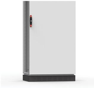
Lo zoccolo anteriore e posteriore consente il cablaggio senza alcuna restrizione in conformità allo standard VDE 0113. L'installazione dei cavi risulta semplice poiché lo zoccolo crea uno spazio aggiuntivo al di sotto della cassa. Le feritoie di ventilazione consentono una ventilazione naturale in questa zona sottostante la cassa.
