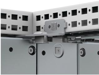
Le piastre di riempimento sono necessarie nel caso di armadi uniti in batteria e forniscono una superficie di montaggio continua quando la piastra non è installata a filo del telaio, aumentando lo spazio disponibile per il cablaggio.
