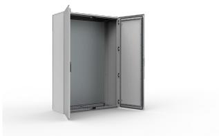
La gamma MKD di armadi compatti in lamiera d'acciaio, con porta doppia e grado di protezione IP 55, è ideale per l'installazione in spazi ristretti dove la porta singola, se aperta, occuperebbe uno spazio eccessivo di fronte all'armadio. La capacità di carico delle porte inoltre è maggiore perché ripartita in due sezioni. L'armadio è adatto a molteplici applicazioni poiché i componenti all'interno dell'involucro sono adeguatamente protetti.
