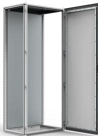
La gamma MCS-HP di armadi componibili in lamiera d'acciaio, con porta singola e grado di protezione IP 66, offre un'elevata protezione per apparecchiature e componenti che permette di allungare il loro ciclo di vita e ridurre i costi di manutenzione quando un armadio deve essere installato in ambienti gravosi. L'armadio mantiene il grado IP 66 anche quando viene unito in batteria, utilizzando lo specifico kit d'unione.
