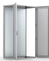
La gamma MCD di armadi componibili in lamiera d'acciaio, con porta doppia e grado di protezione IP 55, è ideale per l'installazione in spazi ristretti dove la porta singola, se aperta, occuperebbe uno spazio eccessivo di fronte all'armadio. La capacità di carico delle porte inoltre è maggiore perché ripartita in due sezioni. L'armadio è adatto a molteplici applicazioni poiché i componenti all'interno dell'involucro sono adeguatamente protetti.
