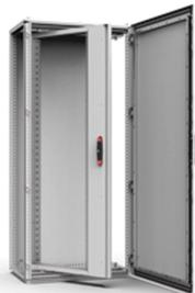
Un telaio girevole per apparecchiature da 19" che fornisce ulteriore spazio di montaggio per tali apparecchiature nonché, una volta aperto, l'accesso posteriore ai componenti e alle apparecchiature installati. Fornisce inoltre uno spazio aggiuntivo per i cablaggi e aumenta la profondità utile per il fissaggio delle apparecchiature al telaio girevole.
