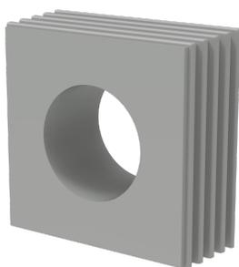
Gli anelli di tenuta CCFG vengono utilizzati insieme ai sistemi di passacavi CCFI e CCFO. La forma conica degli anelli di tenuta consente di inserirli facilmente. Il profilo a onda li rende facili da installare e garantisce una perfetta aderenza intorno ai singoli cavi
