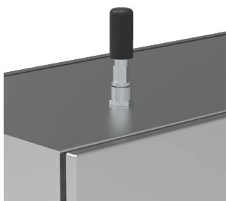
Questo refrigeratore Vortex, BP, con grado di protezione IP 66, è facile da montare, non presenta parti in movimento e non richiede manutenzione. Oltre a svolgere la funzione di raffreddamento, serve anche a ridurre l'umidità relativa all'interno della cassa su cui è montato. Questo refrigeratore Vortex è una soluzione ideale per evitare il surriscaldamento dei componenti all'interno della cassa.
