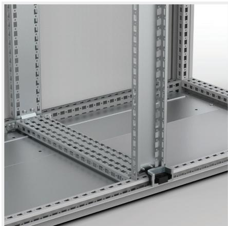
**Descrizione:** Montata al centro di un armadio di larghezza di 1200 mm o 1600 mm (parte superiore e inferiore), per fornire strutture di montaggio standard nelle due sezioni di larghezza di 600 mm o 800 mm. Ciò permette l'inserimento separato di accessori come CAB(P), CBU, CLCK, CLPF, ecc, su ambo i lati dell'armadio. Gli accessori sono regolabili in profondità a passi di 25 mm.
