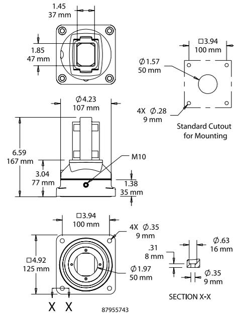
**48-MM ROUND TUBE FLANGE COUPLING AND ADAPTER**
