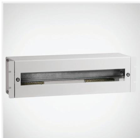
**Descrizione:** Per interruttori, commutatori e prese installate nei rack. Aperture per contenere fino a 22 moduli (18 mm). Guida DIN regolabile in profondità ad intervalli di 15 mm. Il box è dotato di 2 guide di messa a terra 10 x 8 mm. La lunghezza è 120 mm con attacco 15x M5. Sezione ingresso cavi nella parte posteriore 400 x 35 mm con spazzola.
