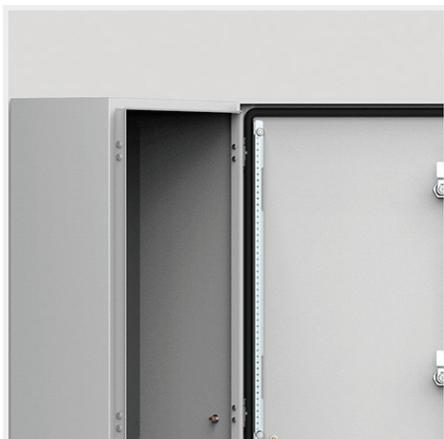
**Descrizione:** Per rinforzare la porta e fornire ulteriori possibilità di montaggio. Montato sulla parte interna della porta sul M6 saldati a pressione. Dotato di una foratura a passo 10 millimetri. Questi profili di porte non possono essere utilizzati con la gamma di casse AFS.
