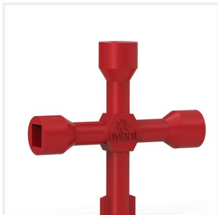
**Descrizione:** Sistema multi chiavi con logo nVent HOFFMAN con sagome differenti per ogni terminale: doppia aletta 5 mm, quadrata 8 mm, triangolare 8 mm e adattatore esagonale standard per utilizzo con diversa viteria.
