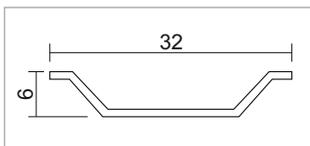
14076 | MOFIRE-32x6 | Molletta di fissaggio posteriore da cartongesso
