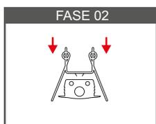
Fissare la staffa di fissaggio al profilo con le click a pressione
