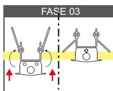
Aprire le molle poste sulla staffa di fissaggio. Inserire il profilo nella fresatura del cartongesso.
