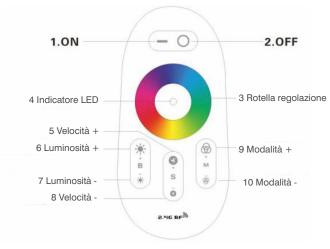
Distanza di trasmissione massima del telecomando: 30m Maximum remote control transmission distance: 30m
