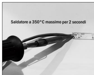
Figura 4. Saldatura dei cavi. Utilizzare stagno senza piombo
