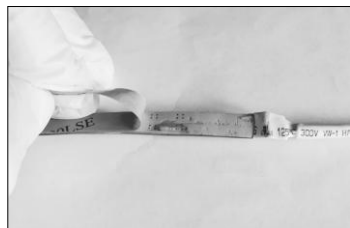
Figura 1. Rimuovere la pellicola protettiva dal nastro biadesivo
