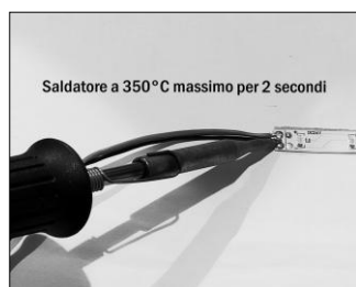
Figura 4. Saldatura dei cavi Utilizzare stagno senza piombo
