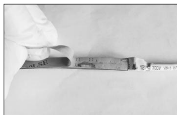
Figura 1. Rimuovere la pellicola protettiva dal nastro biadesivo
