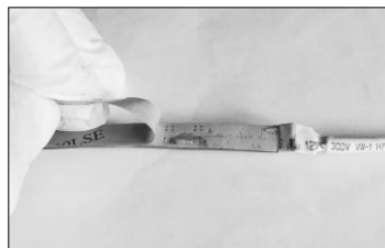
Figura 1. Rimuovere la pellicola protettiva dal nastro biadesivo
