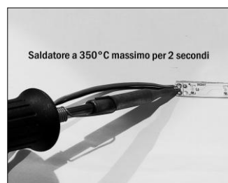
Figura 4. Saldatura dei cavi. Utilizzare stagno senza piombo
