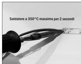
Figura 4. Saldatura dei cavi Utilizzare stagno senza piombo
