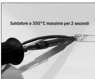
Figura 4. Saldatura dei cavi Utilizzare stagno senza piombo
