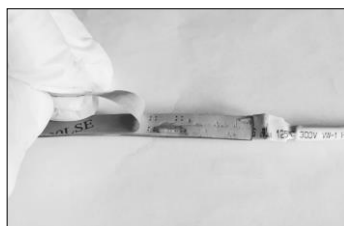
Figura 1. Rimuovere la pellicola protettiva dal nastro biadesivo
