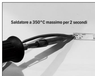
Figura 4. Saldatura dei cavi Utilizzare stagno senza piombo
