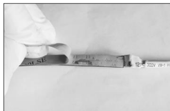
Figura 1. Rimuovere la pellicola protettiva dal nastro biadesivo
