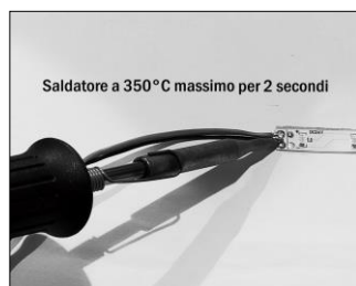
Figura 4. Saldatura dei cavi Utilizzare stagno senza piombo
