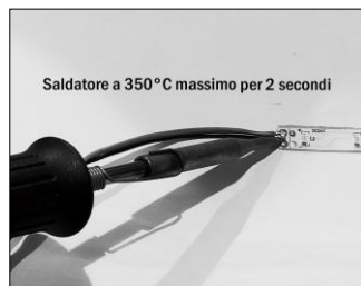
Figura 4. Saldatura dei cavi Utilizzare stagno senza piombo
