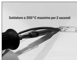
Figura 4. Saldatura dei cavi. Utilizzare stagno senza piombo
