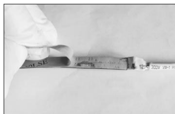
Figura 1. Rimuovere la pellicola protettiva dal nastro biadesivo
