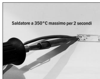
Figura 4. Saldatura dei cavi Utilizzare stagno senza piombo
