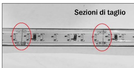
Figura 5a, 5b e 5c. Identificare la sezione di taglio più vicina alla lunghezza desiderata, inserimento tappo di chiusura e aggiunta di silicone per ripristinare il grado IP della striscia LED. NB: Riempire il tappo e la striscia LED di silicone o pasta siliconica specifica per circuiti stampati
