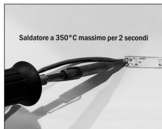
Figura 4. Saldatura dei cavi Utilizzare stagno senza piombo
