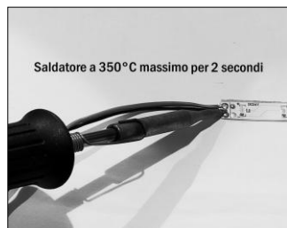
Figura 4. Saldatura dei cavi Utilizzare stagno senza piombo
