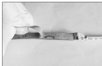
Figura 1. Rimuovere la pellicola protettiva dal nastro biadesivo
