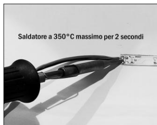
Figura 4. Saldatura dei cavi Utilizzare stagno senza piombo
