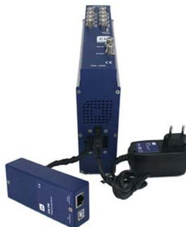
*Figura 4. Connessione del modulo alla fonte*
