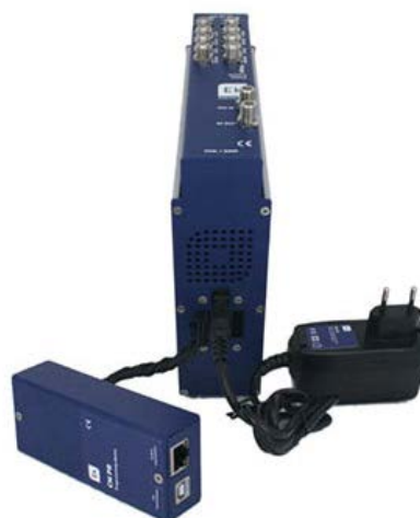
Figura 4. Connessione del modulo alla fonte FA 55 e programmatore esterno CM PR
