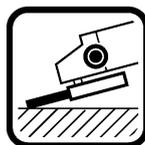
Eseguendo lavori di sgrossatura, i migliori risultati si raggiungono con un'angolatura di appostamento di 30° fino a 40°. In questo modo il pezzo in lavorazione non si surriscalda, non si scolora e non si ha la formazione di scanalature.
