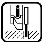
Durante l'operazione di troncatura, non premere, non dare angolature e non oscillare. Operare avanzando moderatamente adattandosi al tipo di materiale in lavorazione.
