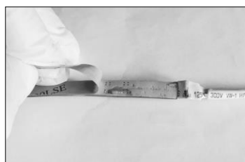
Figura 1. Rimuovere la pellicola protettiva dal nastro biadesivo
