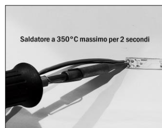
Figura 4. Saldatura dei cavi. Utilizzare stagno senza piombo
