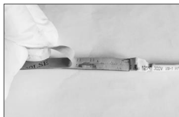
Figura 1. Rimuovere la pellicola protettiva dal nastro biadesivo
