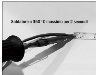
Figura 4. Saldatura dei cavi. Utilizzare stagno senza piombo
