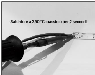
Figura 4. Saldatura dei cavi. Utilizzare stagno senza piombo
