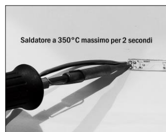
Figura 4. Saldatura dei cavi. Utilizzare stagno senza piombo
