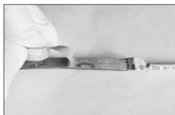
Figura 1. Rimuovere la pellicola protettiva dal nastro biadesivo
