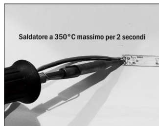
Figura 4. Saldatura dei cavi. Utilizzare stagno senza piombo
