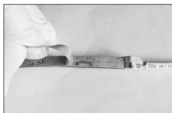
Figura 1. Rimuovere la pellicola protettiva dal nastro biadesivo
