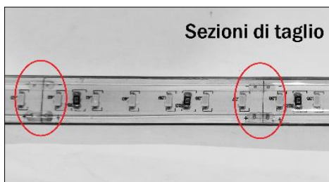
Figura 5a, 5b e 5c. Identificare la sezione di taglio più vicina alla lunghezza desiderata, inserimento tappo di chiusura e aggiunta di silicone per ripristinare il grado IP della striscia LED. NB: Riempire il tappo e la striscia LED di silicone o pasta siliconica specifica per circuiti stampati
