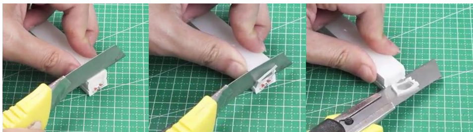
2. Per agevolare la saldatura dei cavi di alimentazione rimuovere la parte eccessiva di guaina con un cutter in modo tale da esporre le piazzole di saldatura.
